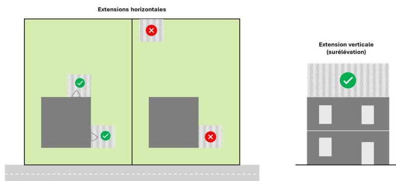
Figure 4 Schéma illustratif. Réalisation : ADEUS
